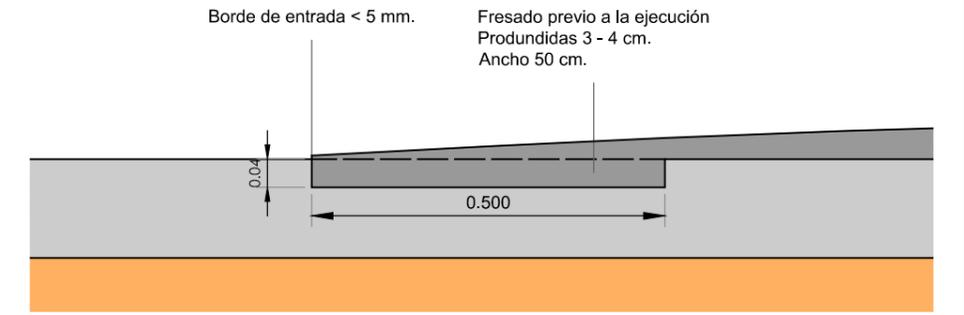
NOTA: Se debe garantizar el drenaje de las aguas que circulan por la calzada de forma que no se produzcan retenciones de agua o encharcamientos en los extremos del reductor de velocidad. Entre las posibles soluciones a considerar se recomiendan:
